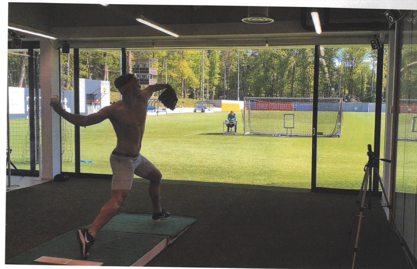
Deze pitcher is volgehangen met reflecterende bolletjes die infrarood licht weerkaatsen. Meerdere camera's vangen dat licht op vanuit verschillende hoeken, en daaruit is in drie dimensies te reconstrueren welke beweging zijn lichaam maakt.
